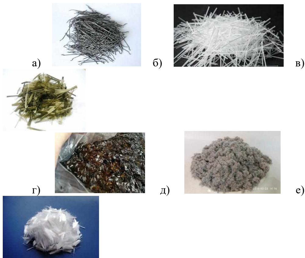
Сурет 2. Фиброталшықты талшықтардың түрлері: а) болатты талшық; б) шыны талшықты талшық; в) базальт талшығы; г) көміртекті талшық; д) целлюлоза талшығы; е) полипропилен талшығы.
