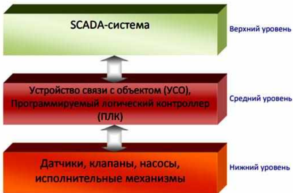
Рисунок 1. Уровни систем промышленной автоматизации
